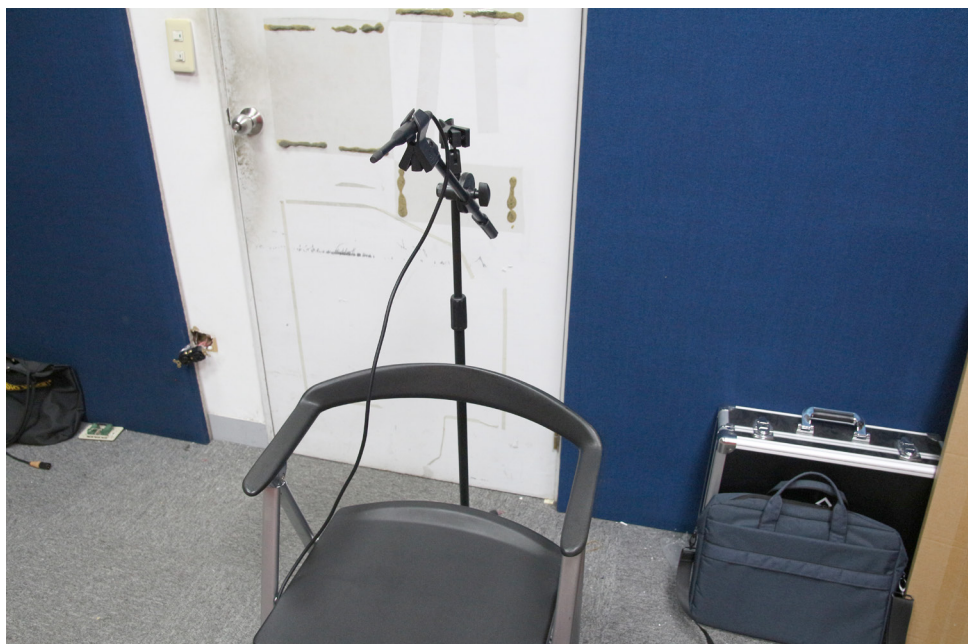
量測麥克風跟落地腳架都是購買時即附贈。這個原廠麥克風並非市場上為求方便的USB輸出，而是專業領域使用的XLR類比輸出，精準度更高。
