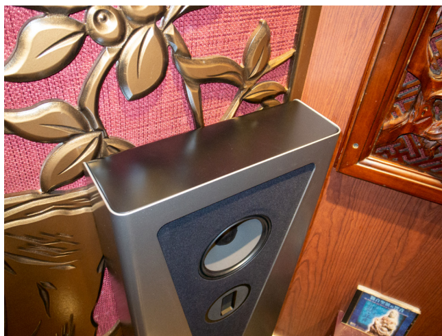
箱體深度只有12公分，前障板再加上3mm厚的U形鋁合金外框，利用複合材質降低箱體共振。
