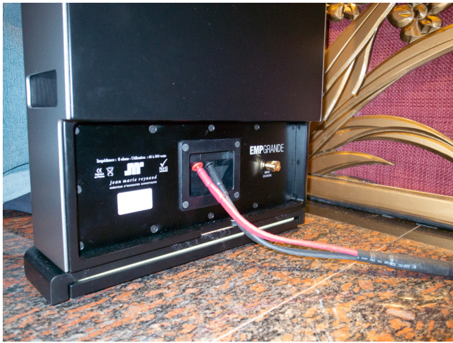
箱體兩側都有一個低音開口，兩者的調諧頻率不同。背板下方除了喇叭端子，還有一個接地端子。請注意底座夾層中的軟性阻尼層。
