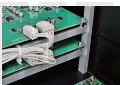
▲ 16聲道聲頻電路是用兩塊8聲道聲頻電路板，Lyngdorf連小處都做得很精良，把聲頻電路板鎖在堅固的「鋁架」上。
