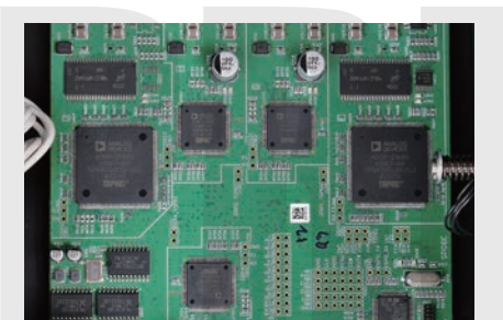
▲ 多聲道解碼電路板使用Analog Devices ADSP-21573與ADSP-21488兩枚SHARC DSP晶片。
