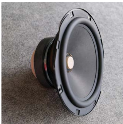
● 8吋中低音單體採用紙盆振膜，連內中的音圈筒也是紙質材料，相位錐是玫瑰木打造。
